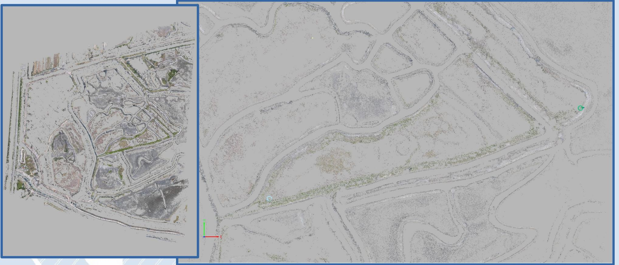
Il primo risultato dell'elaborazione è una Nuvola di Punti denominata "Sparsa" che forma l'ossatura del rilievo fotogrammetrico.
