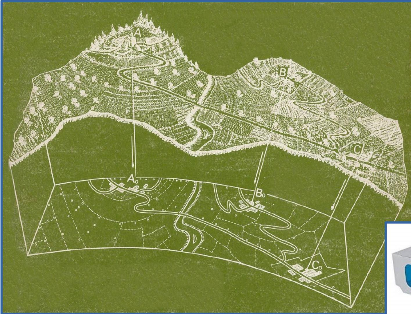
Il concetto di fotorestituzione è quello di “trasferire” una visione stereo di 2 immagini su un disegno planimetrico.
