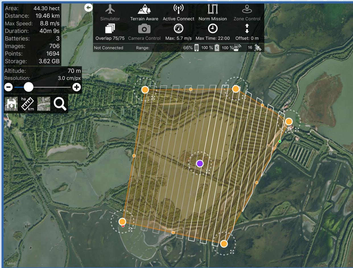
Si seleziona l'area da rilevare, si imposta la quota di volo, la velocità di crociera e la percentuale di sovrapposizione (75-80%).
