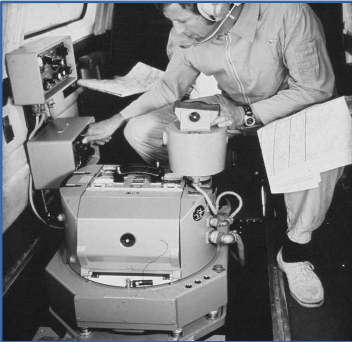
Negli aerei veniva montata una “Camera Metrica” con la quale si scattavano le foto impressionate su delle lastre sensibili che erano sottoposte ad aspirazione per garantire la planarità della pellicola.
