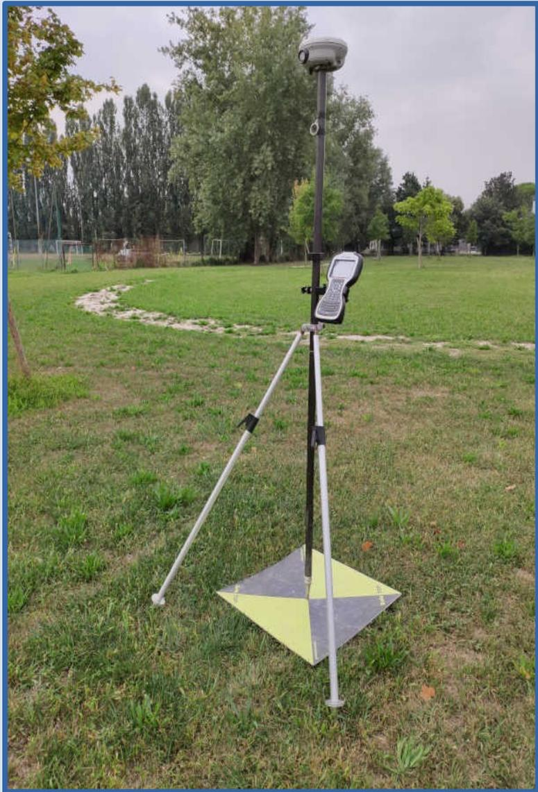
E' necessario quindi stazionare con una strumentazione topografica su ciascuno dei target in modo da rilevare e determinare le coordinate. Operazione propedeutica alla georeferenziazione e alla calibrazione del processo fotogrammetrico (Vincoli).
