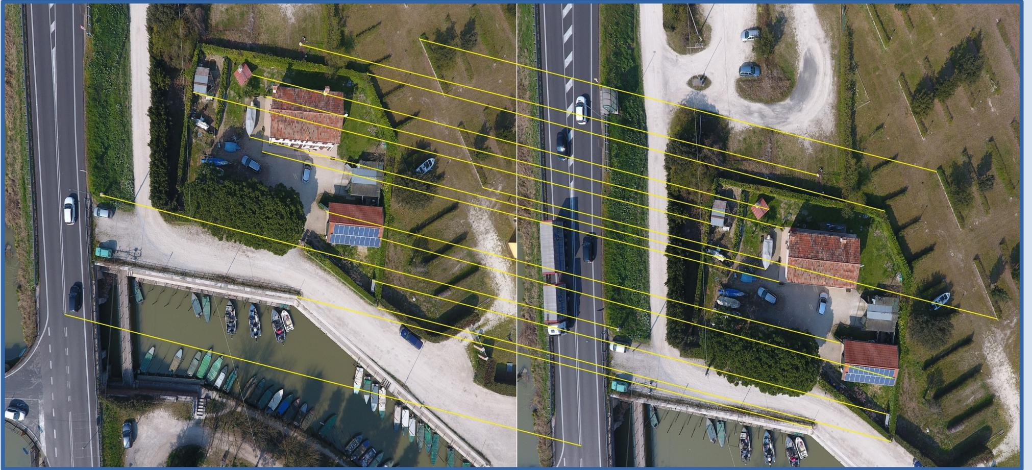
cioè vengono ricercati i punti omologhi fra le foto adiacenti in modo da creare un'allineamento delle stesse e per il matching "accoppiamento" dei singoli pixel.
