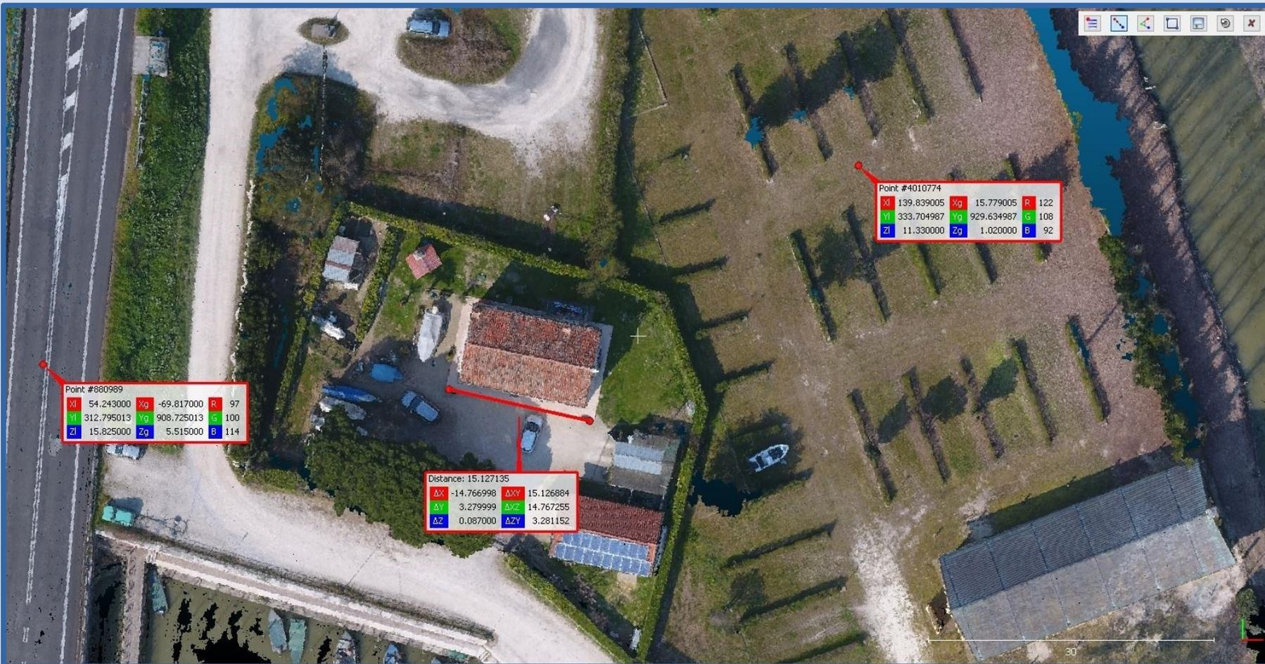
La Nuvola è interrogabile sia per misurare delle distanze sia per conoscere un singolo punto.
